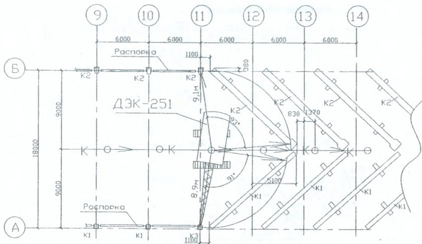
Рисунок 4.4.15 - Схема монтажа колонны способом поворота со смещением стойки относительно поперечной оси вперед по ходу крана
