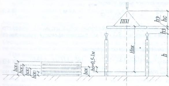
Рисунок 4.4.32 - Схема к определению  $h_{cki}$  при складировании элементов в штабеле
