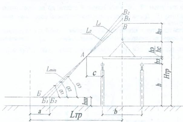
$B_1B_2 \leq BB$  - продолжаем увеличение угла наклона оси стрелы до получения ее минимальной длины. Причем максимальный угол наклона стрелы не должен превышать  $75 - 77^\circ$  и все построение должны производиться со строгим соблюдением масштаба.
