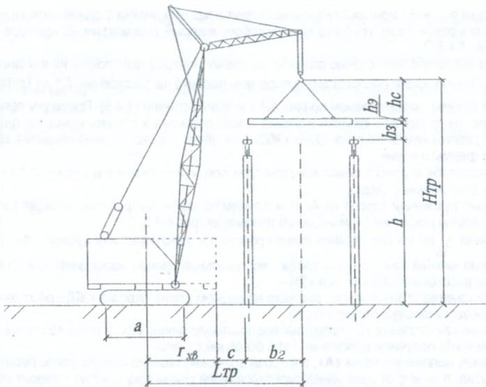
Рисунок 4.4.9 - Схема определения  $H_{стр}$ ,  $L_{стр}$ ,  $L_{тр}$  при монтаже конструкций краном с башенно-стреловым оборудованием
