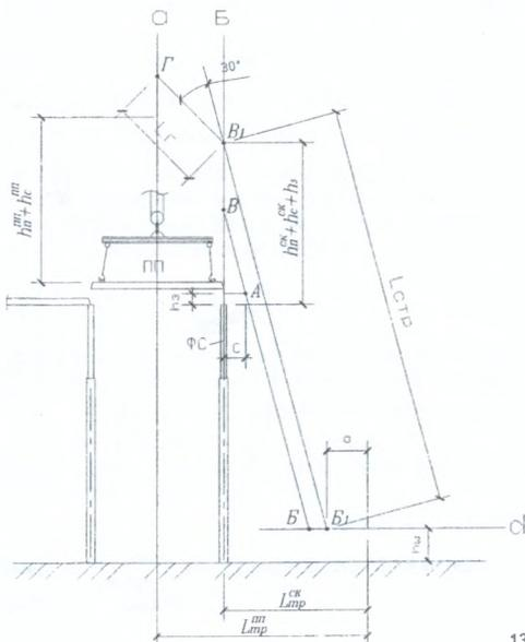
Если расстояние между стропильной конструкцией и точкой «В» по вертикали не менее  $h_n^{CK} + h_c^{CK} + h_3$ , длина стрелы  $L_{стр}$  равна длине отрезка «БВ», в противном случае  $L_{стр}$  принимается равной длине отрезка «Б1В1».
