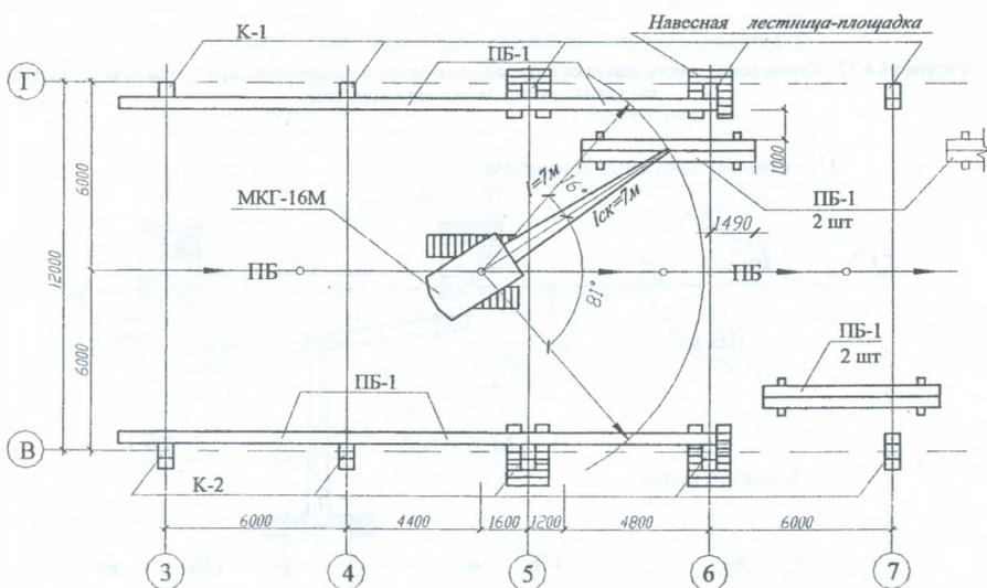
Рисунок 4.4.16 - Схема монтажа подкрановых балок поворотом стрелы крана
