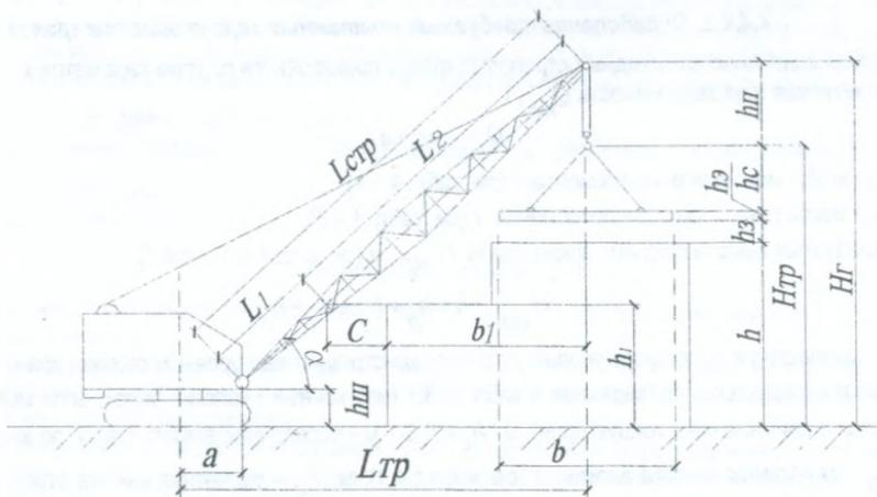
Рисунок 4.4.2 - Схема определения  $H_{мпр}$ ,  $L_{стпр}$ ,  $L_{тр}$  при монтаже конструкций с переносом их через ранее смонтированные конструкции
