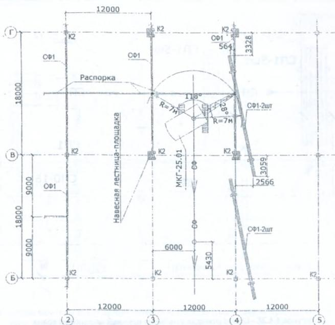
Рисунок 4.4.30 - Схема монтажа стропильных ферм при поперечной схеме движения крана
