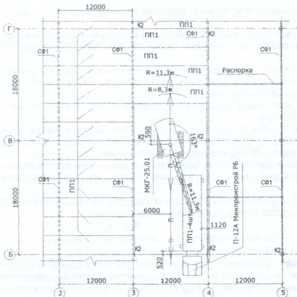
Рисунок 4.4.31 - Схема монтажа плит покрытия при поперечной схеме движения крана
