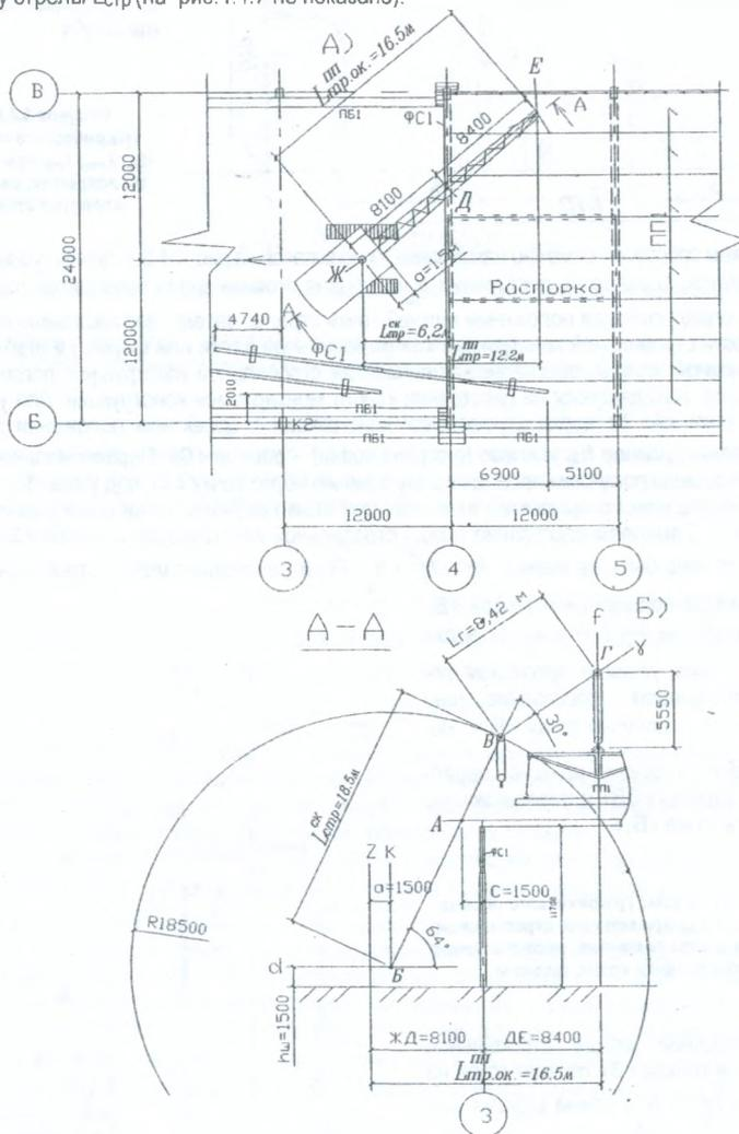
Рисунок 4.4.8 - Схема определения  $L_{стр.ок}$   $L_2$  при монтаже гуськом крана всех плит покрытия ячейки с одной стойки: а - в плане; б - в разрезе «А-А»
