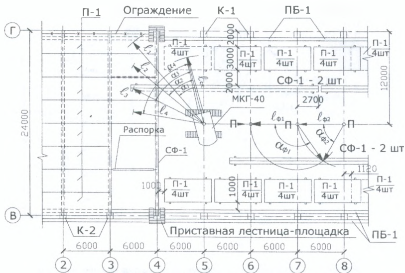
Рисунок 4.4.22 – Схема монтажа конструкций покрытия пролетом 24 м при складировании в одной кассе двух ферм
