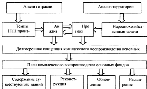
Рисунок 6.1 – Структура анализа необходимости реконструкции
