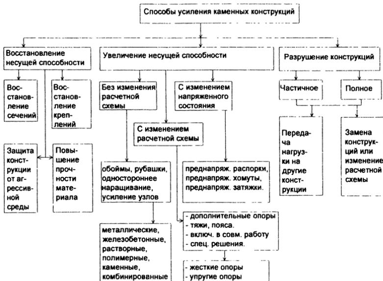
**Рисунок 12.1 – Классификация способов усиления конструкций из каменных материалов**
