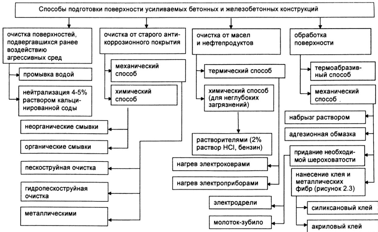
**Рисунок 2.1 – Классификация способов подготовки поверхности бетона к ремонту**
