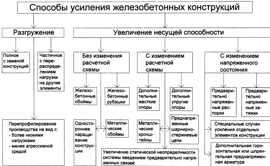
**Рисунок 3.1 – Классификация способов усиления железобетонных конструкций**
