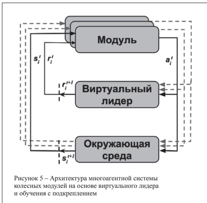
Рисунок 5 – Архитектура многоагентной системы колесных модулей на основе виртуального лидера и обучения с подкреплением
