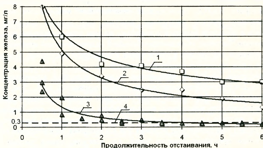
Рис. 2. Зависимость остаточной концентрации железа в промывной воде от времени отстаивания в условиях обработки воды Al_2(SO_4)_3 и Na_3PO_4
