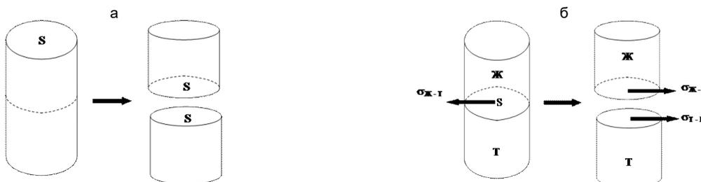
Рисунок 21 –Схема образования новых поверхностей за счет преодоления сил когезии (а), сил адгезии (б)
