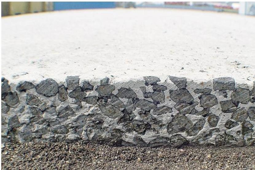
Рисунок 55 – Асфальтоцементобетон
