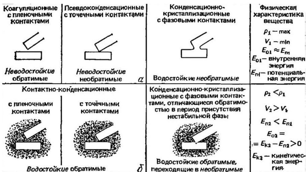
Рисунок 13 - Типы структур и контактов в дисперсных системах
