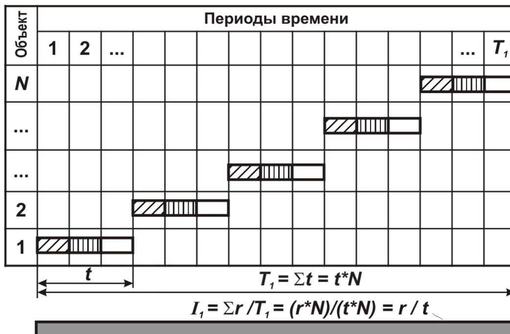
Рисунок 2.1 – Принципиальная схема последовательного метода организации строительства группы объектов
