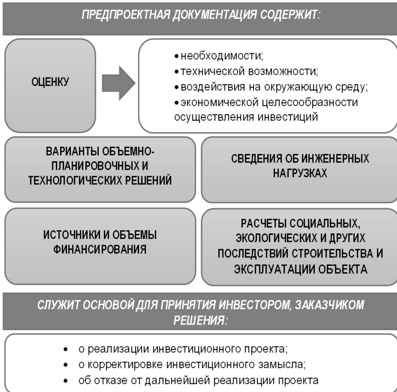
Рисунок 4.5 – Содержание и назначение предпроектной документации[78]
