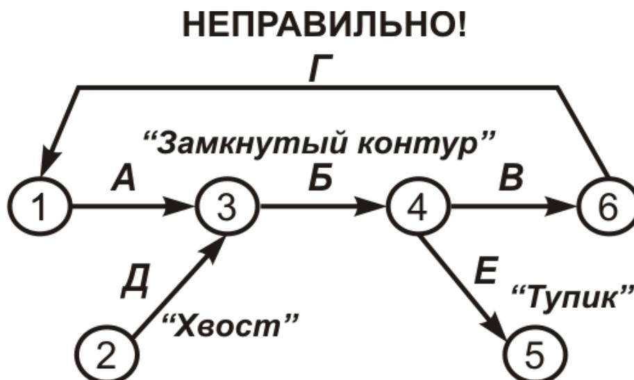
Рисунок 3.8 – Неправильное построение сети с «тупиками», «хвостами», «замкнутыми контурами»
