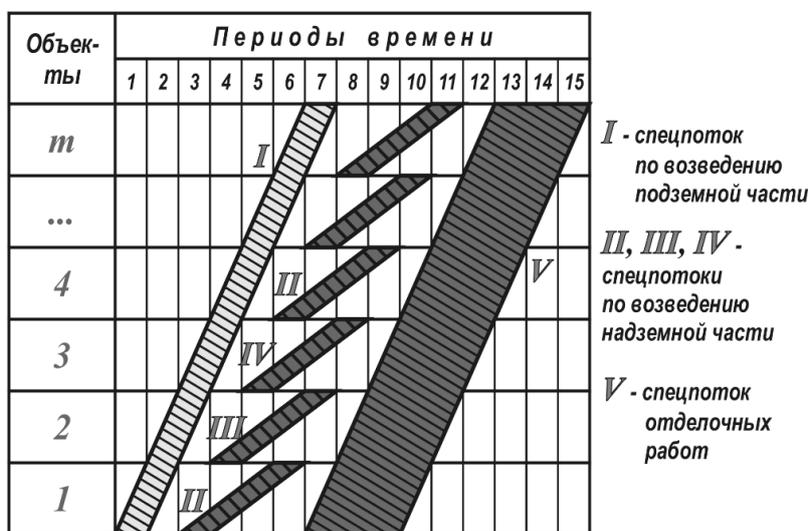
Рисунок 2.17 – Циклограмма объектного потока
