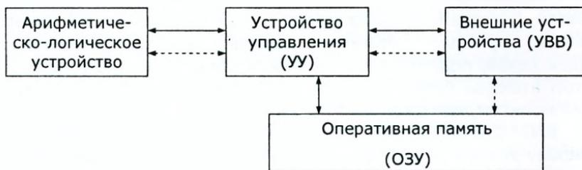
**Рисунок 1.1 – Структурная схема вычислительных устройств по архитектуре фон Неймана**
