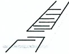
Рисунок 4.9 — Дисперсионная линия задержки на поверхностных акустических волнах
