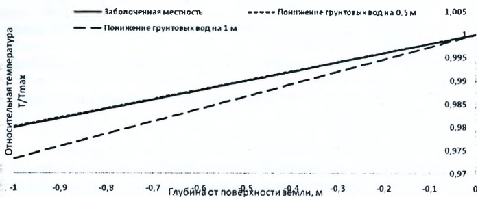
Рисунок 4 – График зависимости относительной температуры от глубины для минеральных почв
