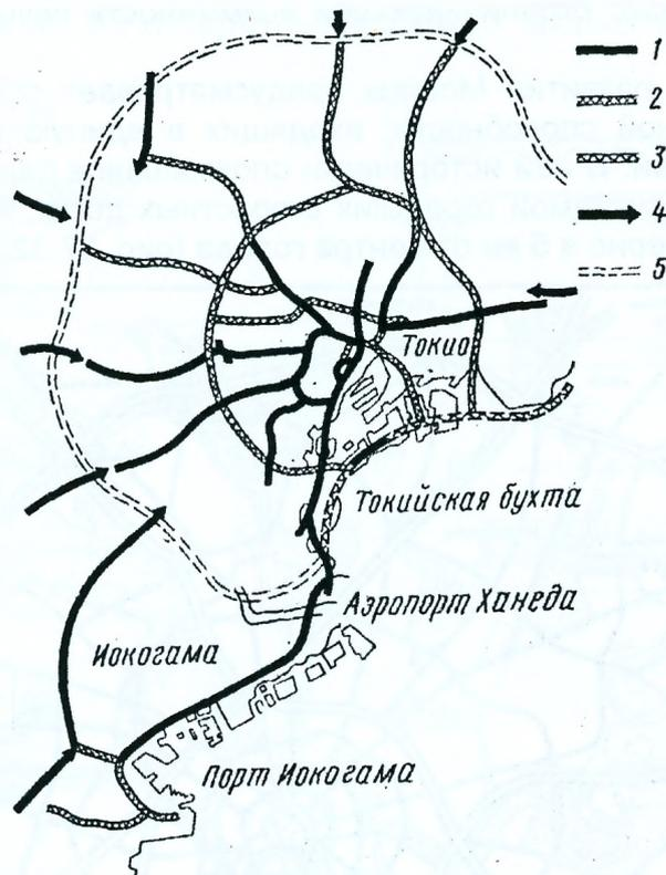
Рис. 27.31. Сеть автомобильных магистралей в Токио: 1 – находятся в эксплуатации; 2 – начато строительство; 3 – проектируются; 4 – примыкающие к городу автомобильные магистрали; 5 – проектируемая кольцевая дорога
