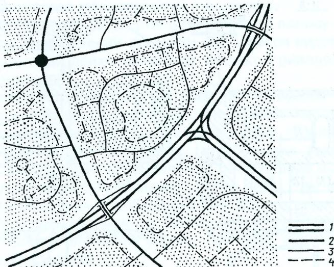
Рис. 27.38. Принципиальная схема планировки городской дорожной сети: 1 – городская автомобильная магистраль; 2 – скоростная городская дорога; 3 – дорога районного значения; 4 – внутриквартальный проезд
