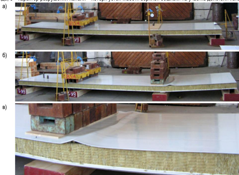
Рис. 7. Испытания панелей по схеме 2
