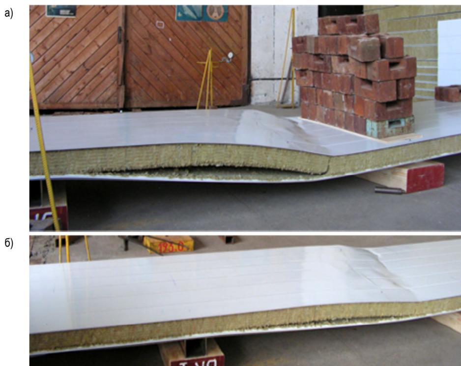
**Рис. 9.** Испытание панели по схеме 3 (испытание №2)
