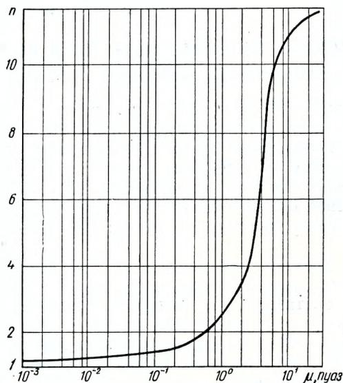
Рис. 5. Зависимость  $n=f(\mu)$  при стесненном осаждении шаров.
