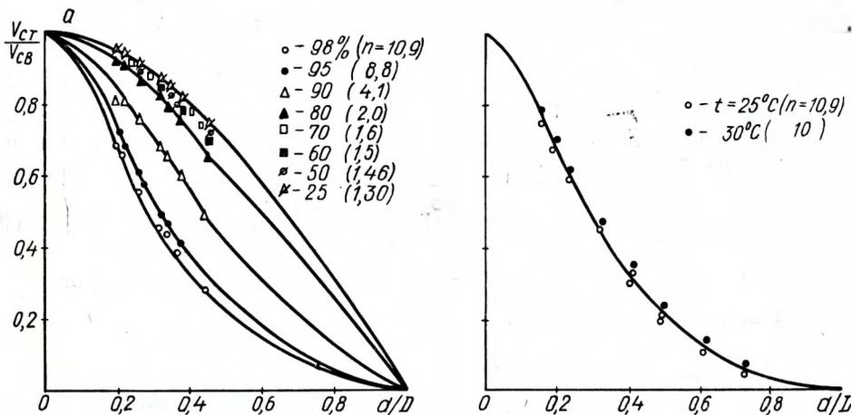
Рис. 4. Стесненное падение стальных ( $\rho_1 = 7,8 \text{ г/см}^3$ ) и стеклянных ( $\rho_1 = 2,98 \text{ г/см}^3$ ) шаров в глицерине и водных растворах глицерина различной концентрации (%):
