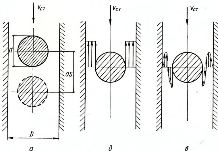
Рис. 2. Схема стесненного осаждения шаров (а) в идеальной жидкости (б) и в вязкой (в).
