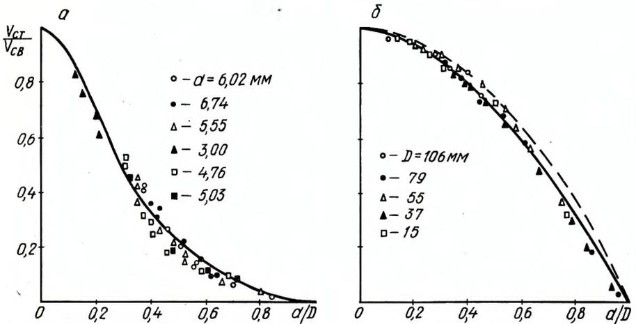
Рис. 1. Стесненное падение стальных ( $\rho_1=7,8$  г/см<sup>3</sup>) шаров: а — в глицерине ( $\mu=14,99$  пуаз;  $\rho=1,258$  г/см<sup>3</sup>); б — в воде ( $\mu=0,01$  пуаз;  $\rho=1,0$  г/см<sup>3</sup>) на а сплошная кривая — теоретическая при  $n=11,3$ ; на б сплошная кривая — теоретическая при  $n=1,225$ , пунктирная — то же при  $n=1,0$ ;  $v_{ст}$  — скорость стесненного осаждения;  $v_{св}$  — то же свободного.
