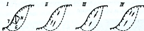
Рис. 6.5 Схема сил, действующих на склоне: I - параллелограмм сил; II - при K_{ycm} > 1 ; III - при K_{ycm} = 1 ; IV - при K_{ycm} < 1 .
