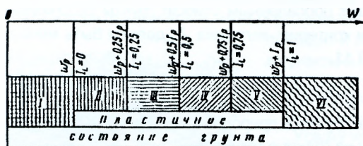
Рис. 8.8 График состояния глинистых грунтов в зависимости от влажности: I - твердое состояние; II - полутвердое; III - тугопластичное; IV - мягкопластичное; V - текучепластичное; VI - текучее.
