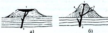
Рис. 4.17 Разрез вулканов: а - гавайский тип, б - тип Везувия, Кракатау, Пеле, 1 - кратер; 2 - побочные кратеры; 3 - жерло; 4 - вулканическая гора (конус).
