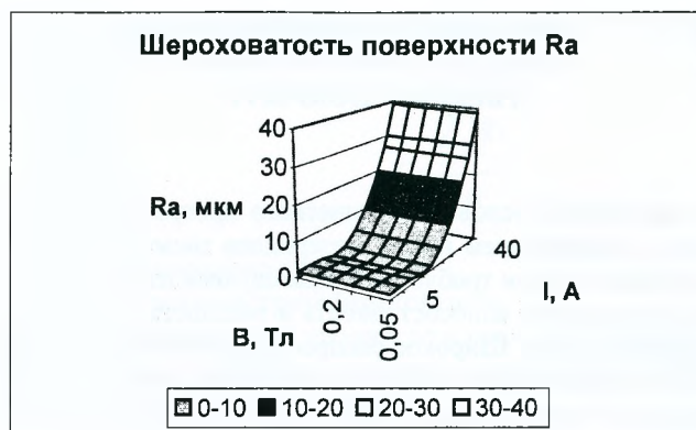
Рисунок 1 — Диаграмма зависимости производительности обработки и шероховатости поверхностей наплавленных сормайтотом от I и B при V = 12,5 м/с; H = 0,1 мм; S = 13,3 мм/с
