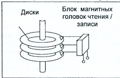
Рис. 1.10. Принцип устройства жесткого диска
