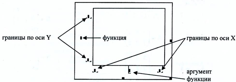
Рисунок 50 – Шаблон для построения плоского графика функции
