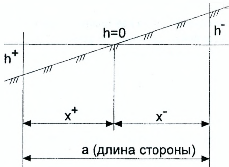
Рисунок 13 – Схема определения положения точки нулевых работ
