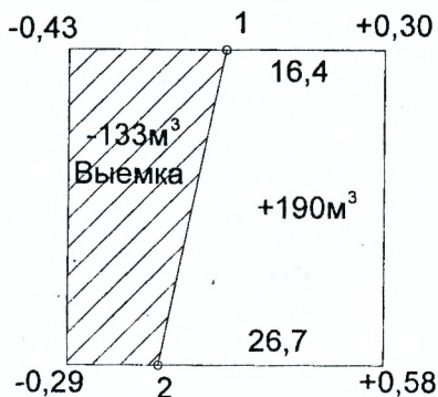
Рисунок 14 – Схема определения объема земляных работ
