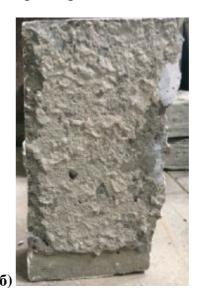
Рисунок 2 — Общий вид разрушения образцов: а) с использованием добавки в количестве 0,4%, б) с использованием добавки в количестве 0,7%.
