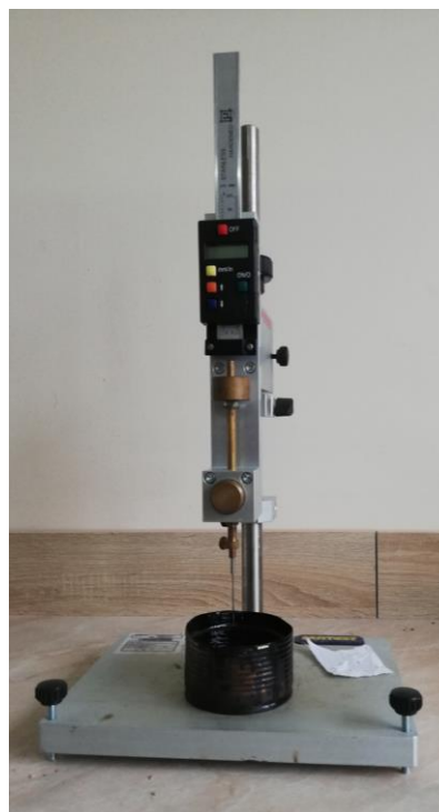
1 – рейка кремальеры, 2 – шкала, 3 – плунжер, 4 – направляющая втулка, 5 – тормозное устройство, 6 – груз-шайба, 7 – игла и держатель, 8 – кристаллизационная чашка, 9 – пенетрационная чашка, 10 – опорный столик, 11 – регулируемый винт
