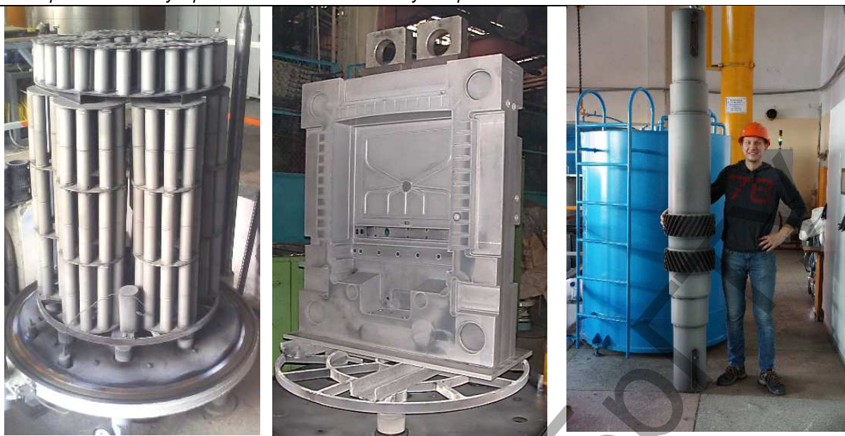
Рисунок 3 – Некоторые виды изделий, упрочняемых методом ионного азотирования
