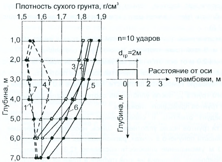
Рис. 7.4 Изменение плотности сухого грунта по глубине: 1 - до уплотнения; 2,3,4 – после уплотнения трамбовкой с плоской подошвой соответственно при y=0 ; y=1,0 м, y=3,0 м; 5,6,7 – после уплотнения трамбовкой со ступенчатой подошвой соответственно при y=0 ; y=1,0 м, y=3,0 м
