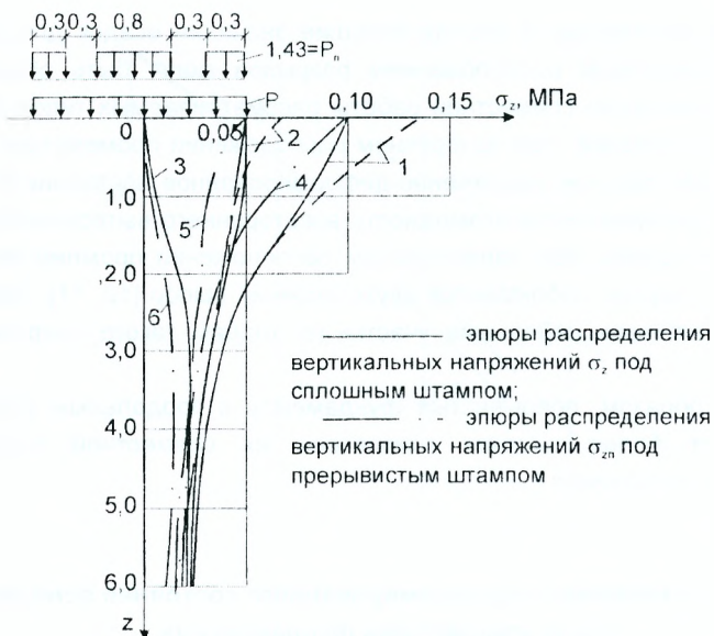
Рис. 3.8 Эпюры распределения вертикальных напряжений: 1 – по оси, проходящей через центр штампов; 2 – по оси, проходящей через край штампов; 3 – по оси, находящейся на 0,5В от края штампов; 4, 5, 6 – по осям, проходящим через центр, край и на 0,5В от края штампа соответственно при P_n=0,1 МПа
