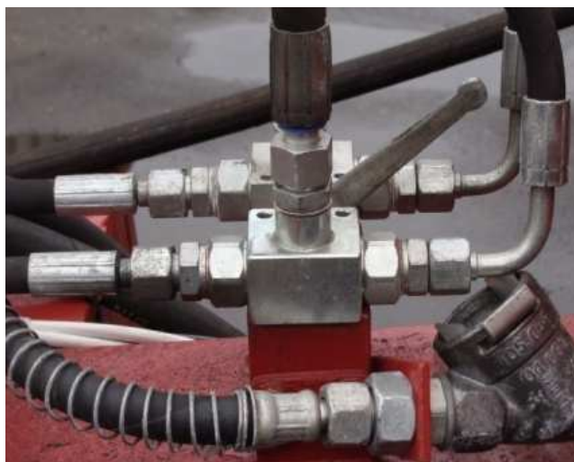
Рисунок 6 – Спаренный шаровый трехходовой кран
