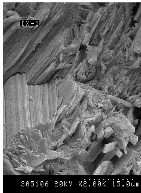
Рис. 2. Слоистая структура цементного геля:
