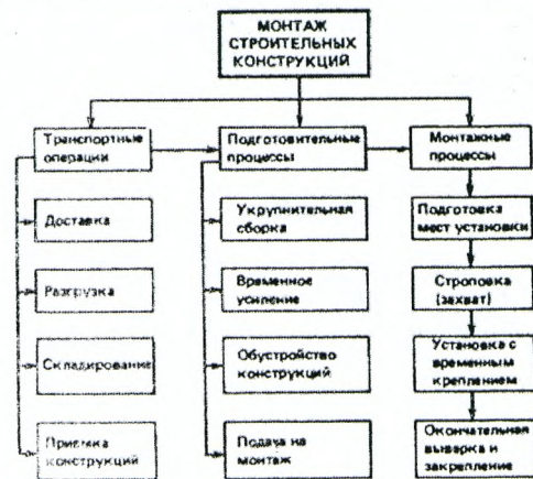
Рис. 1. Схема технологического процесса монтажа строительных конструкций
