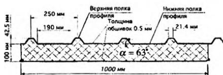
Рис. 2. Поперечное сечение панели покрытия
