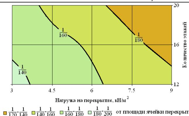
Рис. 3. Номограмма для определения оптимальной площади сечения колонн
