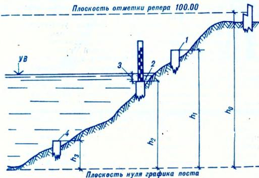
**Репер водомерного поста.** Схема отсчётов и отметок на свайном водомерном посту: 1 — отметка свай 97.00; 2 — отметка свай 96.30; 3 — отсчёт по рейке 8 см; 4 — отметка свай 95.50;  $h_0 = 600$  см;  $h_1 = 300$  см;  $h_2 = 230$  см;  $h_3 = 150$  см; УВ — уровень воды.
