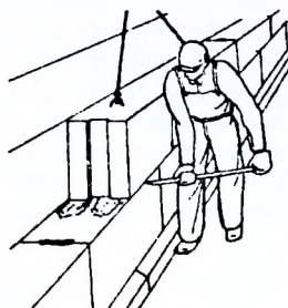
Рис.4.4.48 - Схема выверки фундаментного блока
