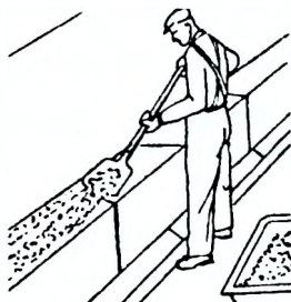
Рисунок 4.4.45 - Схема устройства растворной постели
