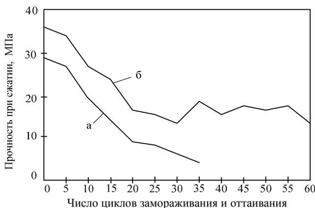
**Рис. 2.** Зависимость прочности образцов при сжатии от числа циклов замораживания и оттаивания
