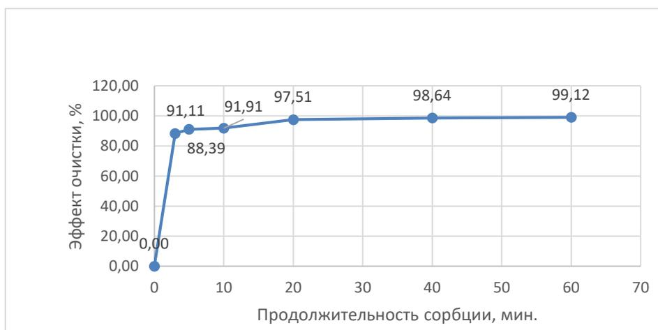
**Рисунок 1 – Зависимость эффекта сорбции ионов  $Cd^{+2}$  от продолжительности контакта, мин.**
