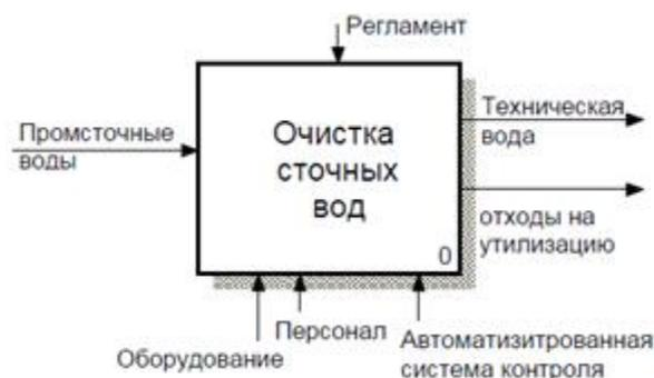
*Рисунок 2 – Контекстная диаграмма модели. Диаграмма дерева узлов модели очистки сточных вод с автоматизированным контролем*
