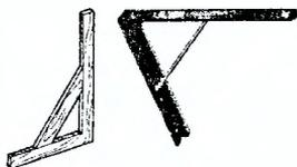
**Угольник** деревянный или металлический размером 500×700 мм служит для разметки и проверки прямых углов каменной кладки.
