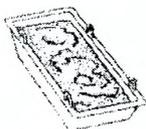
**Металлический растворный ящик** объемом  $0,24 \text{ м}^3$  служит для подачи раствора и устанавливается на рабочее место каменщика. Допускается подъем в гирлянде (до шести ящиков одновременно).
