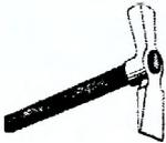
**Молоток-кирочка** массой 550 грамм с деревянной ручкой длиной 300 мм используется для рубки и тески кирпича. При рубке кирпича лезвие молотка должно быть под прямым углом к поверхности кирпича. Может быть использован для осаживания ранее уложенного кирпича, а также для устранения отклонений, возникающих при кладке углов, ограничений и т.д.
