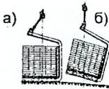
**Вилочный захват** применяется для подъема поддона с кирпичом и подачи в зону работы каменщика: а – положение поддона до подъема; б – положение поднятого поддона.
