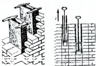
**Буйки** деревянные и металлические короба с сечением по размерам дымовых или вентиляционных каналов, высотой на 6–8 рядов кладки. Позволяют существенно увеличить производительность труда при кладке вентиляционных каналов в каменных стенах, обеспечивают постоянное сечение канала и предохраняют его от засорения раствором.
