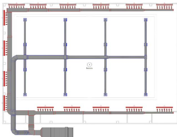
Рисунок 1 – План с нанесением элементов системы кондиционирования при схеме вытеснением.
