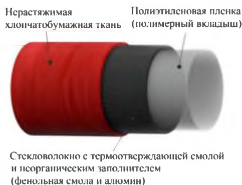
Рисунок 3 – Структура облицовки
