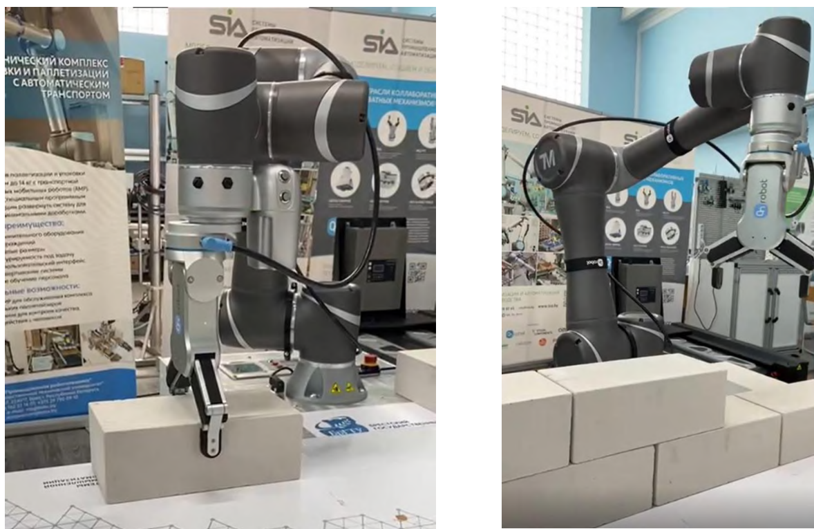
Рисунок 2 – Мобильный роботизированный комплекс для автоматизации процесса кирпичной кладки – «Робот-каменщик» на выставке BUDEXPO – 2021
