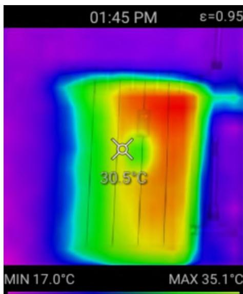
Рис. 1 Алюминиевый радиатор Gretta-500 на экране тепловизора
