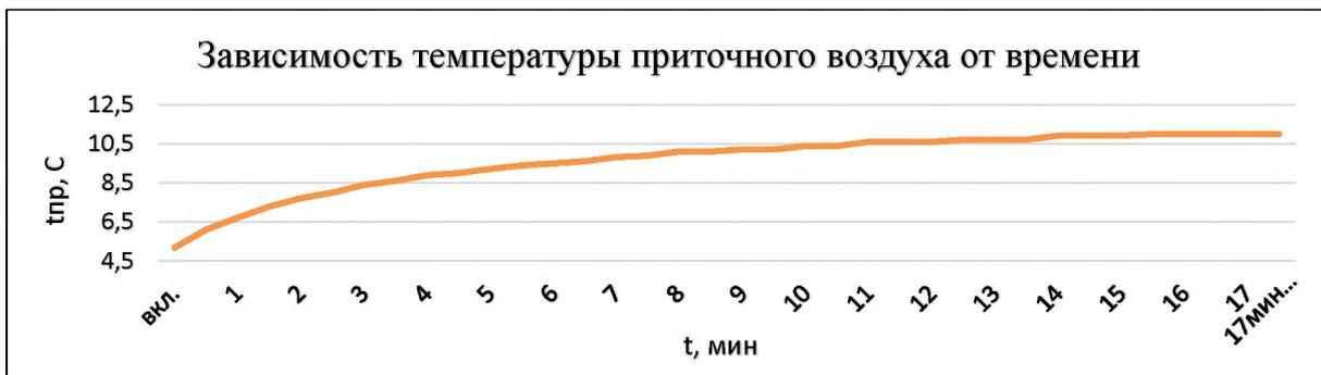
Рисунок 7. График зависимости температуры приточного воздуха от времени
