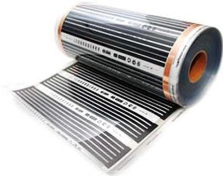
Пленочный инфракрасный электрический пол на основе углеродных нагревательных элементов. Укладывается непосредственно на старое напольное покрытие или подготовленное основание. Не требует устройства стяжки или слоя плиточного клея.
