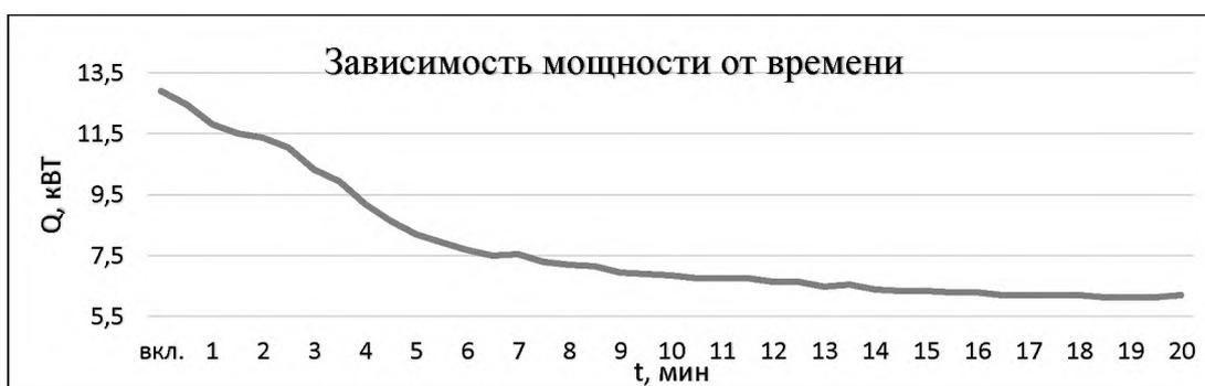
Рисунок 4. График зависимости мощности от времени
