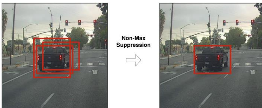
Рисунок 4 – Результат использования метода NMS
