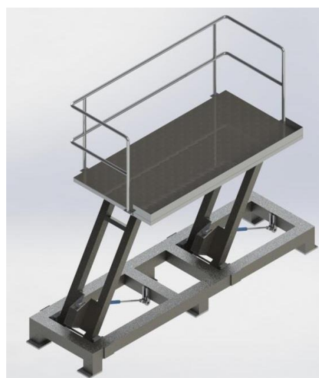
Рисунок 4 – Площадка для распиловки туш
