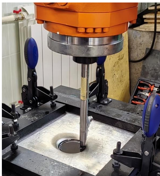
Выполнение технологической операции при работе по криволинейной траектории
