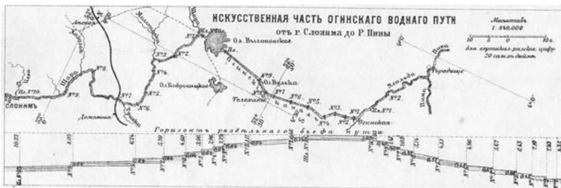
Рисунок 1 – Схема водного пути Огинского канала
