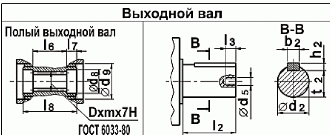
Рисунок 3.10 – Общий вид, габаритные и присоединительные размеры червячного редуктора 2Ч-80 [18]
