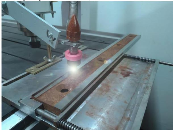
**Рисунок 1 – Схема обработки ножа гильотинных ножниц плазменной струей**
