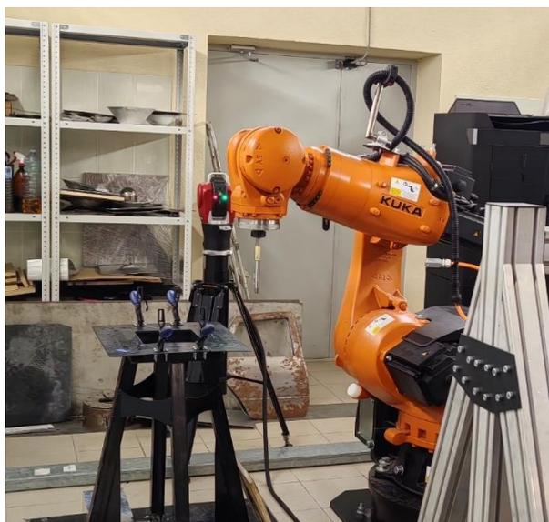
**Рисунок 3 – Общий вид экспериментальной установки для отработки системы компенсации отклонений инструментального центра робота-манипулятора от заданной траектории.**
