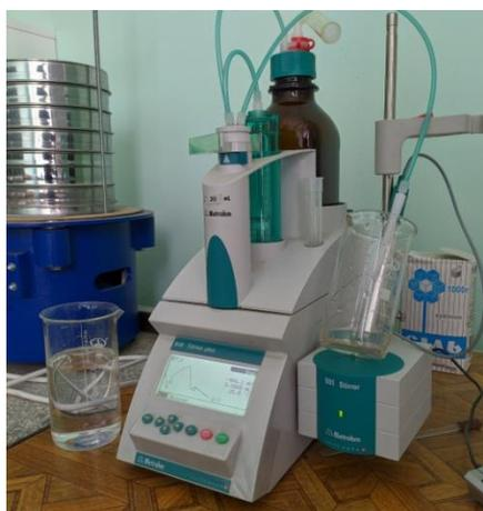
*Рисунок 1 – Определение ионов хлора в водных вытяжках*
