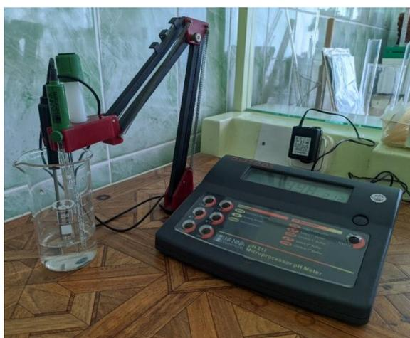
*Рисунок 2 – Определение рН в водных вытяжках*
