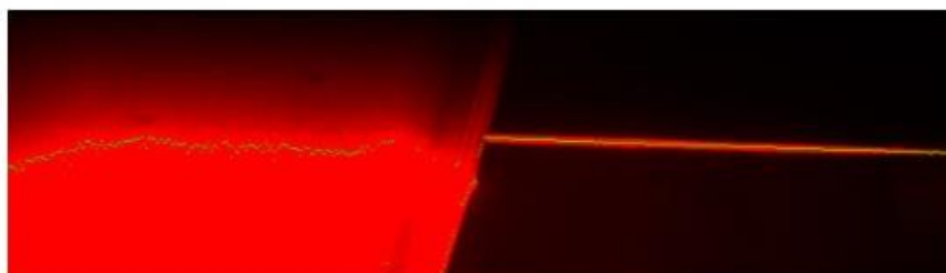
Увеличиваем время экспозиции. Профиль черного объекта выделяется корректно, светлого - нет.
