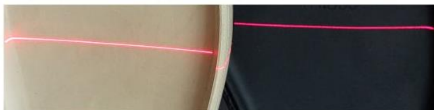
В поле зрения сканера два объекта, один светлого цвета, другой — темного.
