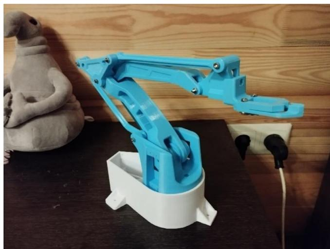
*Рисунок 3 – имитационная модель робота-манипулятора в сборе*
