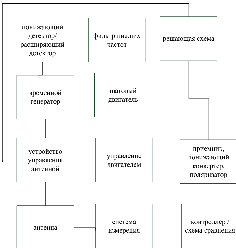
Рисунок 2 – Структура контроллера антенны
