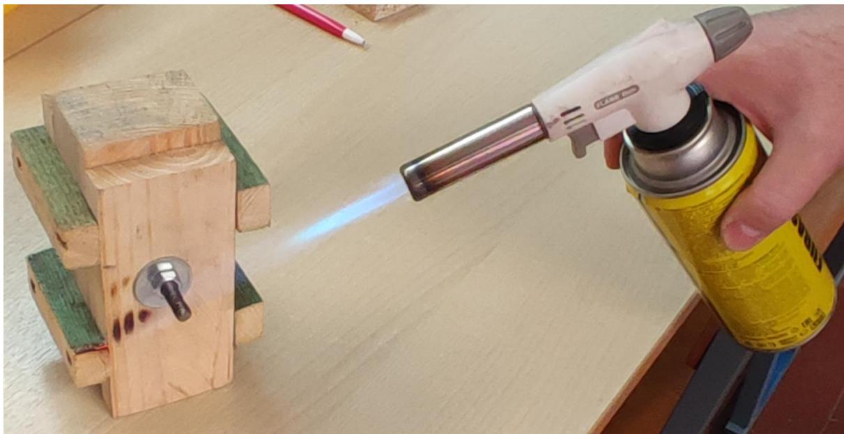
*Рисунок 2 – Локальное воздействие высокой температуры на шпильки*
