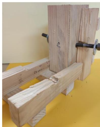
*Рисунок 7 – Образец после прогрева 9 минут*
