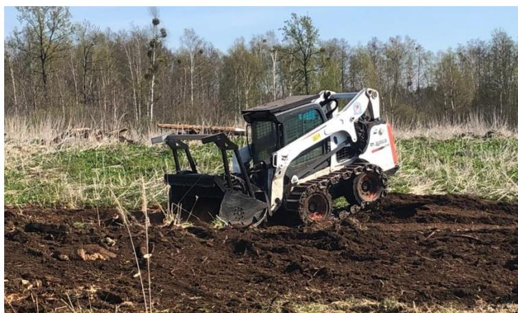
**Рисунок 2 – Мобильная дробилка (кустореz) «Bobcat» на базе погрузчика «Bobcat» с бортовым поворотом S770 (общий вид и работа в полевых условиях),**
